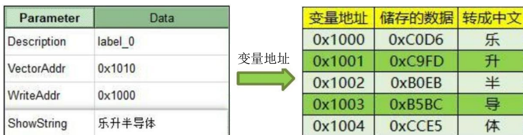
图 7-1：变量地址内数据的储存方式
